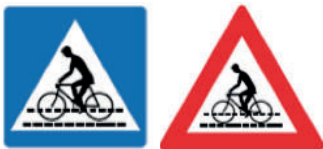
Verkehrszeichen bei einer Radüberfahrt und Anzeige einer nähernden Radüberfahrt
